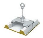
Point d'ancrage pour tôle trapézoidale en acier, épaisseur de la tôle 0.5 mm Entre axe des trous 280-333 mm
